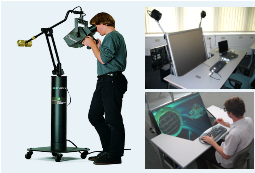
Abbildung 3: links: »Fakespace BOOM 3C« (1994) am Fraunhofer IAO, rechts: Eigenentwicklung »Picasso« (2004).
